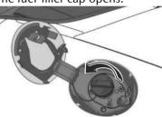
6. Place the fuel-filler cap on the fuel-filler lid holder.
