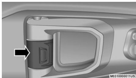
Manual Door Lock
