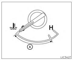
ENGINE COOLANT TEMPERATURE GAUGE
