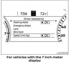
TURNING THE TRAFFIC SIGN RECOGNITION (TSR) SYSTEM ON AND OFF
