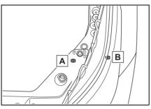
A Boulon de réglage A B Boulon de réglage B
