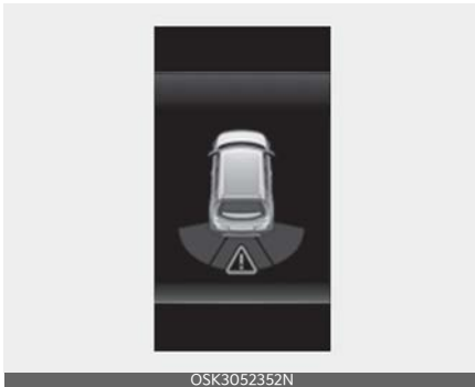
A: Ultrasonic sensor error or blockage
