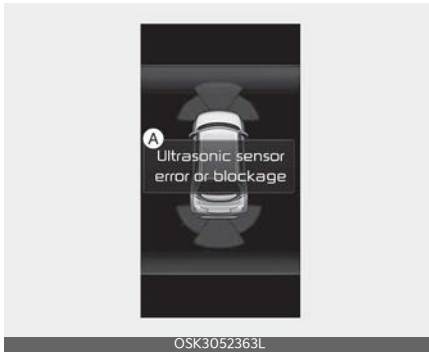
A: Ultrasonic sensor error or blockage
