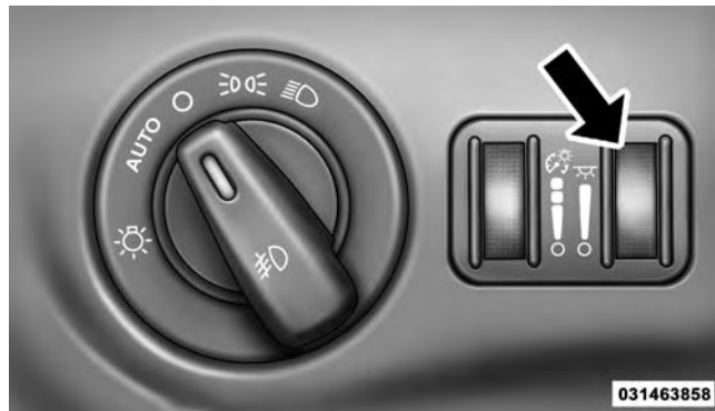
Door Handle/Ambient Light Dimmer
