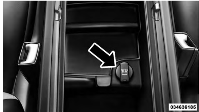
Center Console 12 Volt Power Outlet
