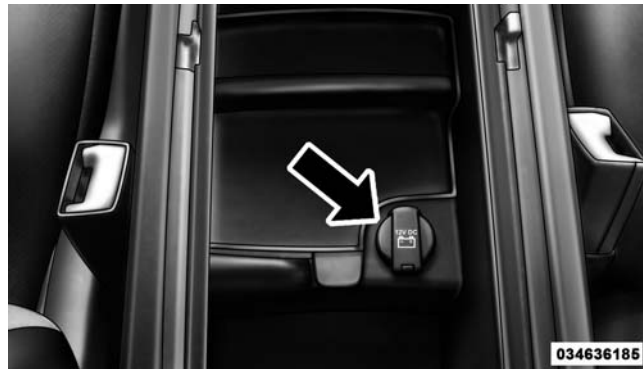
Center Console 12 Volt Power Outlet
