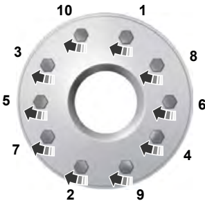
10-lug nut torque sequence
