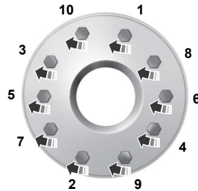
10-lug nut torque sequence
