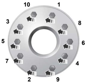
10-lug nut torque sequence
