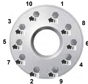
10-lug nut torque sequence
