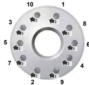
10-lug nut torque sequence
