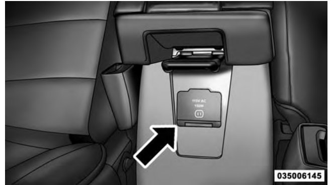
115 Volt Power Outlet
