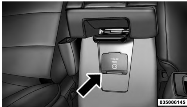
115 Volt Power Outlet
