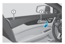
► To unlock and open a front door: pull door handle (2).
