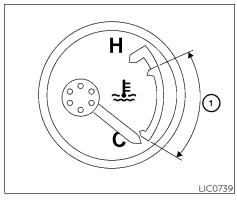
ENGINE COOLANT TEMPERATURE GAUGE
