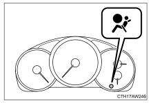
Un système de diagnostic continuellement contrôle fonctionnalité du système d'airbag SRS (y-compris les prétensionneurs des ceintures de sécurité avants) lors de la conduite du véhicule. Le témoin lumineux du système d'airbags l'opération SRS montrera normale en s'allumant pendant environ 6 secondes quand le contacteur de démarrage est mis en position "ON".
