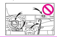
Ne fixez rien aux portes, à la vitre du pare-brise, aux vitres latérales, aux montants avant et arrière, au rail latéral de toit et à la poignée de maintien.
