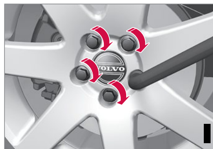
Tighten the lug nuts
