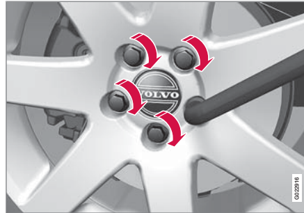
Tighten the lug nuts
