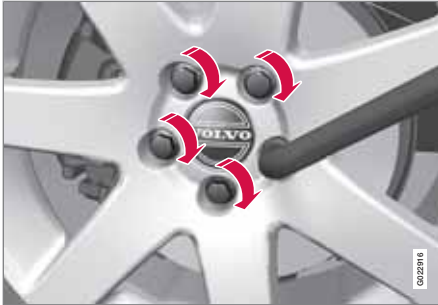
Tighten the lug nuts
