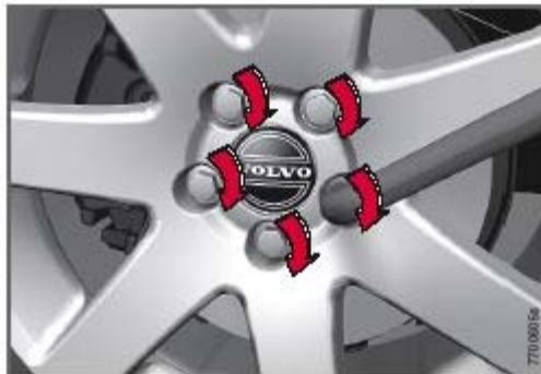
Tighten the lug nuts
