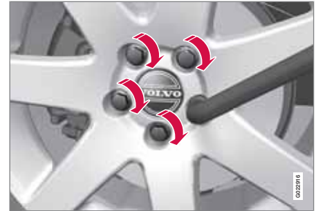
Tighten the lug nuts
