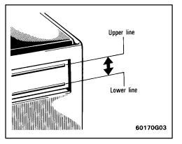
CHECKING BY THE FLUID LEVEL LINES (MAINTENANCE TYPE BAT-TERY ONLY)
