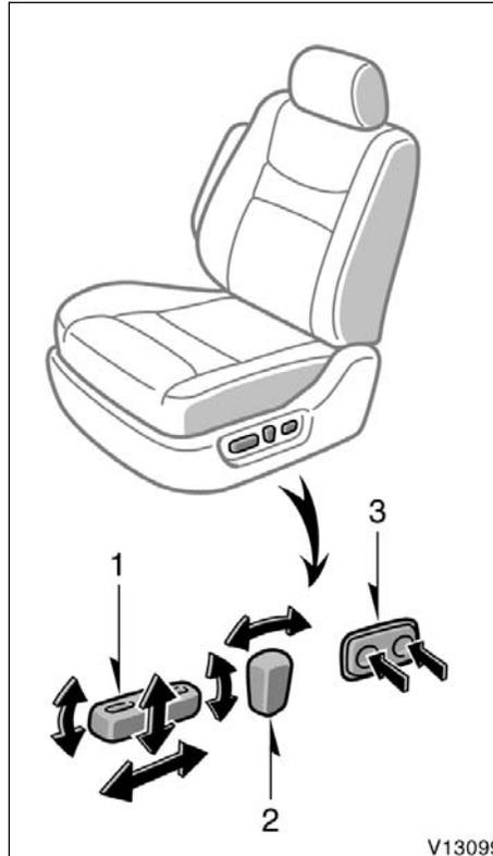
**1. SEAT POSITION AND SEAT CUSHION ANGLE/HEIGHT ADJUSTING SWITCH**
