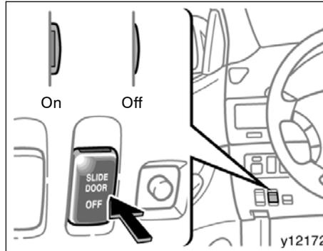
**POWER SLIDING DOOR MAIN SWITCH ("SLIDE DOOR OFF" switch)**
