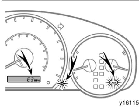
**VEHICLE-TO-VEHICLE DISTANCE CONTROL MODE FAILURE WARNING**
