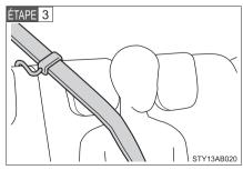
L'élastique doit être placé derrière la ceinture de sécurité.
