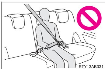
N'utilisez pas la ceinture de sécurité centrale arrière si l'une des boucles est retirée. Fixer une seule boucle pourrait occasionner des blessures graves, voire mortelles, en cas de freinage brusque ou de collision.
