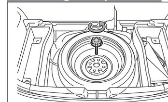
Loosen and remove the bolt.
