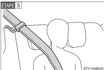
L'élastique doit être placé derrière la ceinture de sécurité.
