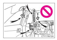
Ne rien fixer aux portes, à la vitre de pare-brise, aux vitres latérales, aux montants avant et arrière, au rail latéral de toit et à la poignée de maintien.
