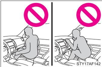
● Ne pas s'asseoir sur le bord du siège et ne pas s'appuyer contre la planche de bord.
