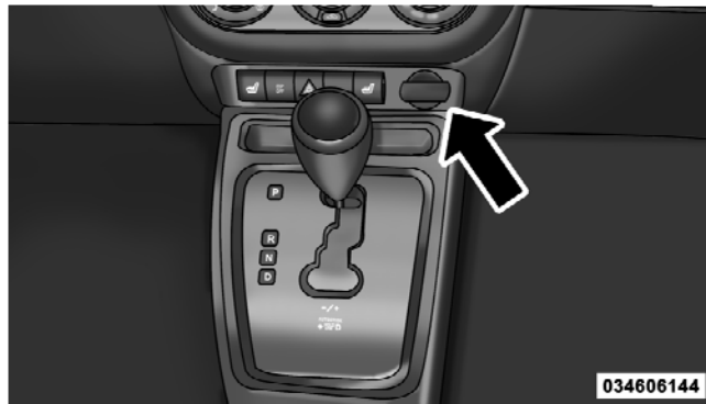
12 Volt Power Outlet
