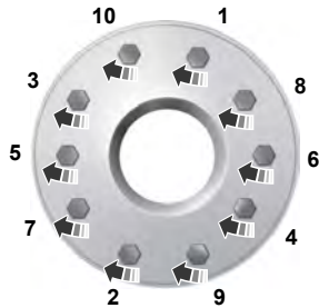
10-lug nut torque sequence
