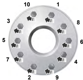
10-lug nut torque sequence
