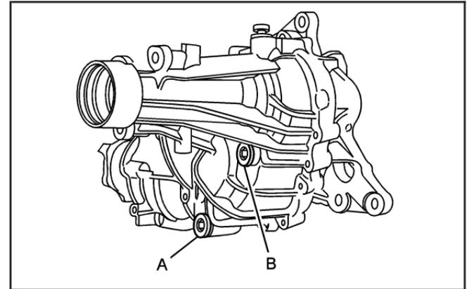
**(A) Drain Plug (B) Filler Plug**
