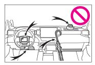
Ne rien fixer sur les parties telles que les portes, la vitre de pare-brise, les vitres latérales, les montants avant et arrière, les rails latéraux de toit et les poignées de maintien.
