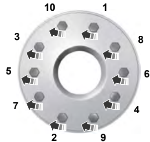
10-lug nut torque sequence
