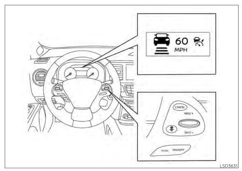
VEHICLE-TO-VEHICLE DISTANCE CONTROL MODE OPERATION
