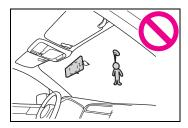
Ne fixez pas d'accessoires sur la garniture de la porte ou à proximité des coussins gonflables latéraux SRS et ne placez pas d'objets à proximité des coussins gonflables latéraux SRS. En cas de déploiement des coussins gonflables latéraux SRS, ils pourraient être projetés dangereusement vers les occupants du véhicule et causer des blessures.
