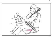
Ne vous asseyez pas ou ne vous penchez pas près des portes. Les coussins gonflables latéraux SRS sont logés dans les deux dossiers des sièges avant à côté de la porte. Ils assurent leur protection en se déployant rapidement en cas de collision par le côté. Toutefois, la force de déploiement d'un coussin gonflable latéral SRS peut blesser un passager dont le corps est trop près du coussin gonflable SRS.
