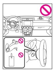
Ne placez aucun objet sous le côté conducteur du tableau de bord. En cas de déploiement du coussin gonflable de genoux SRS, ces objets pourraient interférer avec son fonctionnement correct et pourraient être propulsés à l'intérieur du véhicule et causer des blessures.
