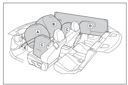
A Coussin gonflable frontal SRS du conducteur: dans la partie centrale du volant
