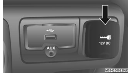
12 Volt Power Outlet
