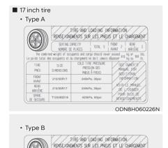
SEE OUNER'S COLD TIRE PRESSURE TIRE PNEU PNEUS À FROID FRONT 215/55R17 240kPa, 35psi 215/55R17 240kPa, 35psi ODN8H069224N
