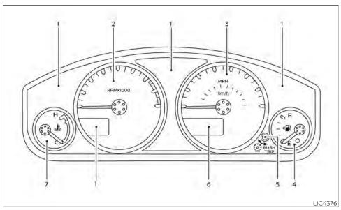
SPEEDOMETER AND ODOMETER
