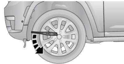
Loosen Lug Nuts
