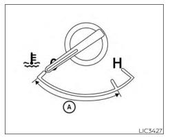
ENGINE COOLANT TEMPERATURE GAUGE
