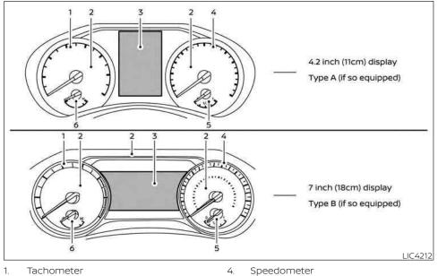
SPEEDOMETER AND ODOMETER
