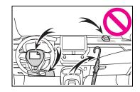
Ne fixez rien aux portes, à la vitre du pare-brise, aux vitres latérales, aux montants avant et arrière, au rail latéral de toit et à la poignée de maintien. (Sauf pour l'étiquette de limitation de vitesse)
