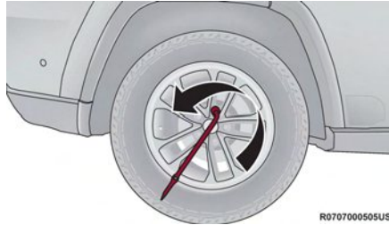
Loosen Lug Nuts
