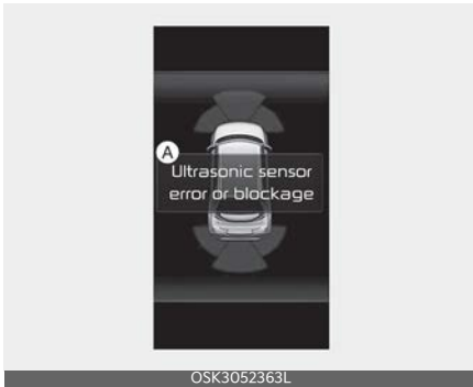
A: Ultrasonic sensor error or blockage
